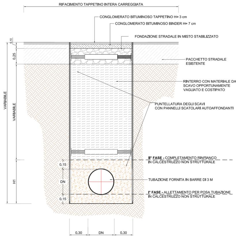
SEZIONE DI SCAVO TIPO "A"
