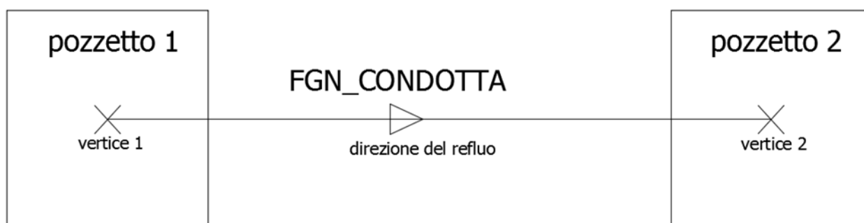
Figura 21 – Schema di disegno in GIS – Esempio di rappresentazione del verso di una condotta
