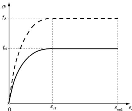
Figure 1: Legame parabola rettangolo per il calcestruzzo
