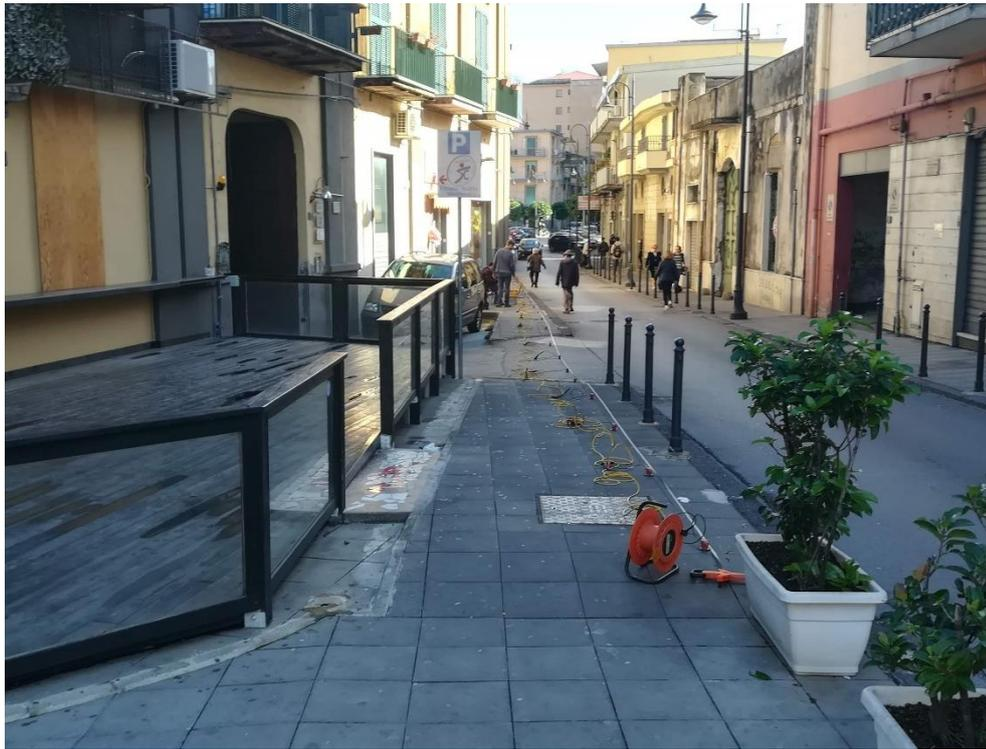
**Foto n. 3: Stendimento sismico MASW n. 3 in via Martinez y Cabrera**
