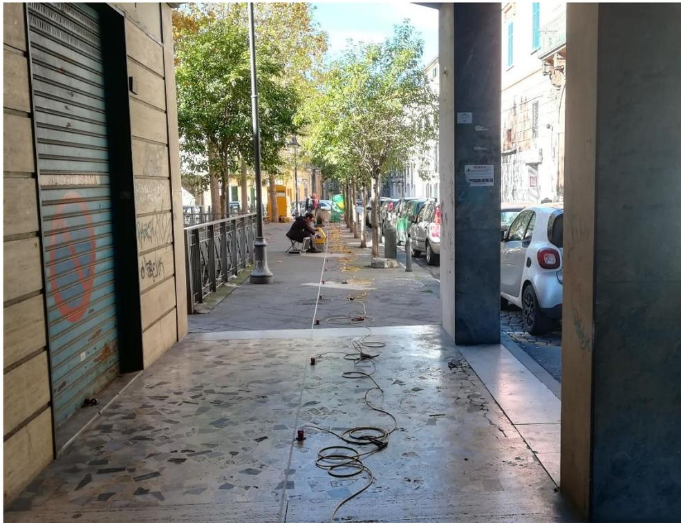
**Foto n. 1: Stendimento sismico MASW n. 1 in via Solimena**
