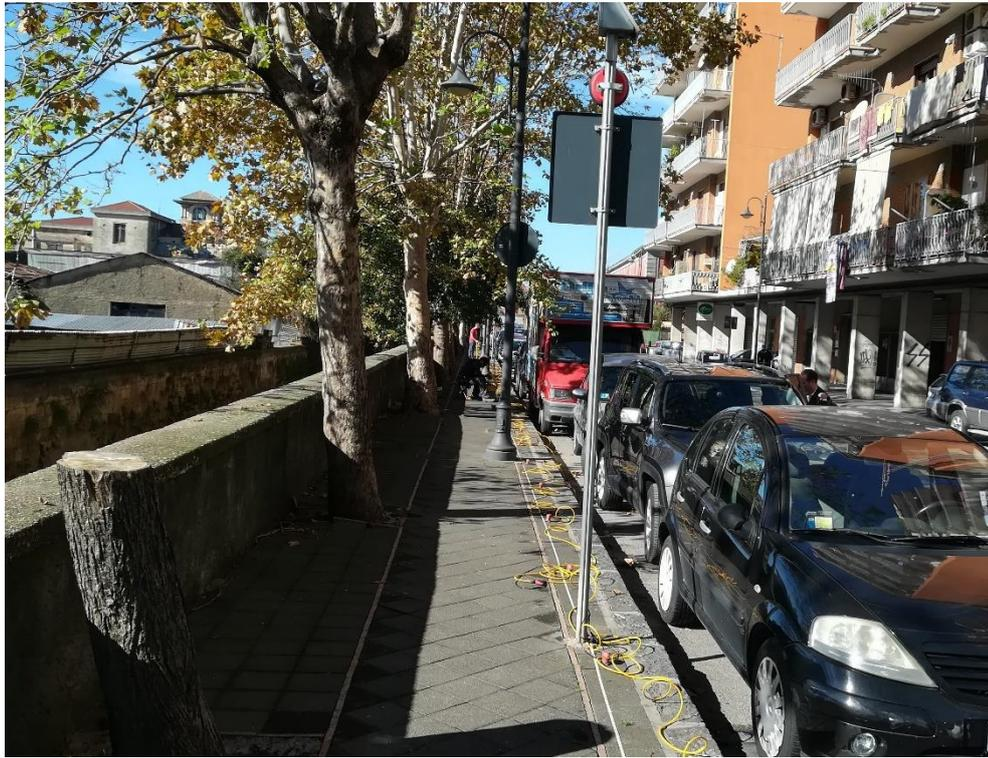
**Foto n. 2: Stendimento sismico MASW n. 2 in via Pucci**
