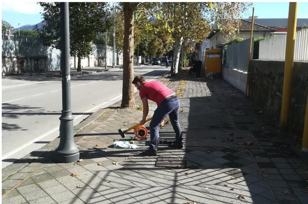
**Figura 17: Sorgente energizzante, costituita da massa battente su piastra di alluminio. Lo starter/trigger è un geofono verticale Geospace a 14Hz.**
