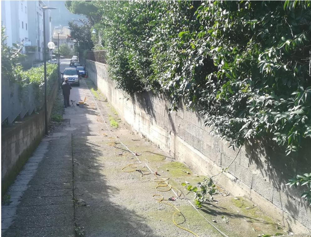
**Foto n. 4: Stendimento sismico MASW n. 4 in via Spera**
