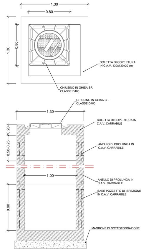
**PARTICOLARE POZZETTO DI ISPEZIONE SU TUBAZIONE IN PRFV**
